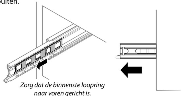
Til de lade op aan de zijkanten en plaats één van de laderails (ongeveer 15 mm) op een zijrail aan de binnenkant.
