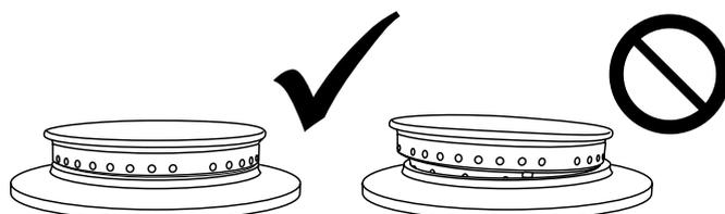
Die Brennerauslässe dürfen nicht blockiert sein. Bei Blockierungen entfernen Sie hartnäckige Partikel mit einem Stück feinem Draht.
