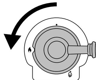
Houd de knop ingedrukt zodat het gas een paar seconden door de brander kan vloeien. De ontsteker moet dan gaan vonken en het gas aansteken.
