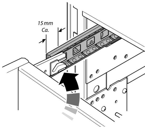
Drehen Sie die Schublade, um die verbleibende Schiene auf der gegenüberliegenden inneren Seitenschiene zu platzieren.
