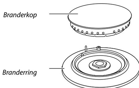
Zorg er bij het aanbrengen van de branderkop voor dat deze goed in de ring komt te zitten.
