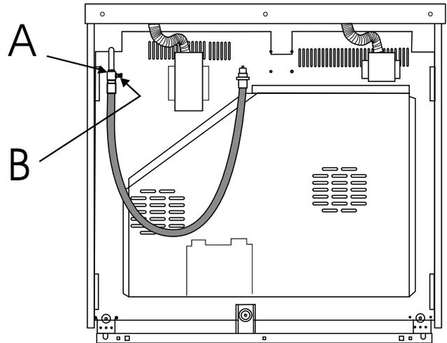
Den Schlauch an den Steckverbinder anschließen.
