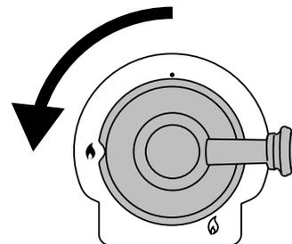
Halten Sie den Regler einige Sekunden lang gedrückt, damit das Gas zum Brenner strömen kann. Durch die Funken der Zündung wird das Gas entzündet.
