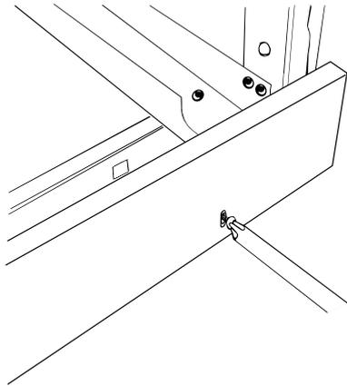
Die drei Schrauben für die Sockelhalterungen entlang der vorderen Unterkante des Herds entfernen. Den Sockel mit diesen Schrauben anbringen (andersfarbige Schrauben finden Sie im losen Zubehör).
