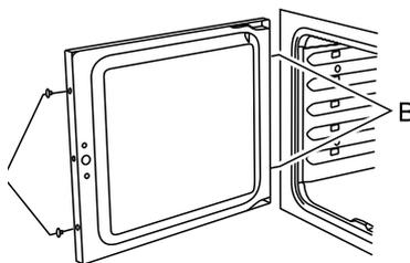
Die Ofentür öffnen. Die beiden Schrauben „A“ und die beiden Schrauben „B“ von der Tür entfernen. Die äußere Türverkleidung entfernen. Die Ersatzverkleidung an der Ofeninnentür anbringen.
