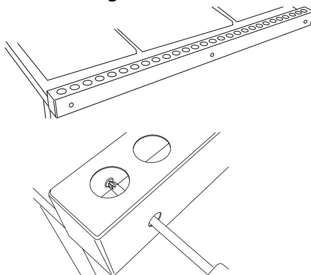
Die Abzugleiste ist getrennt verpackt. Die größeren der Löcher an den Seiten sind für den Schraubendreher bestimmt und sollten nach hinten weisen. Die Schrauben und Muttern im Lieferumfang benutzen, um die Leiste zu befestigen.
