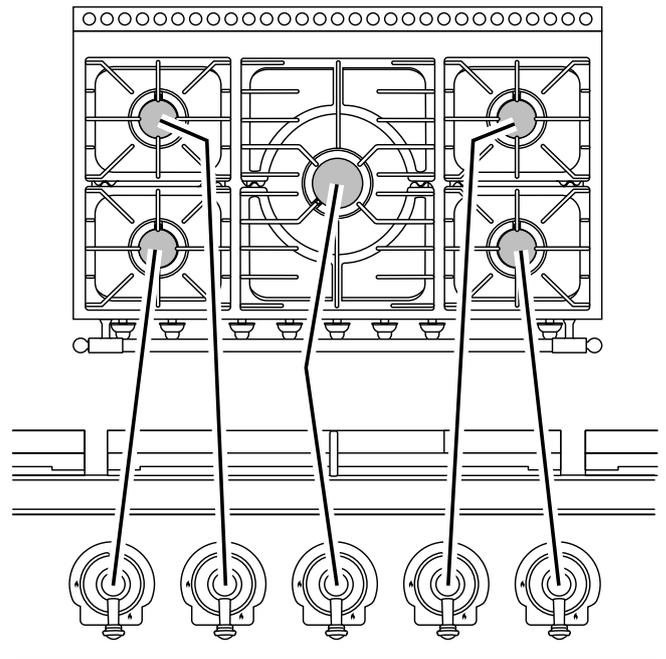
Er is een vonkontstekingsysteem dat werkt als de knop ingedrukt wordt. Elke brander is ook speciaal beveiligd zodat de gastoevoer gestopt wordt zodra de vlam uitgaat.
