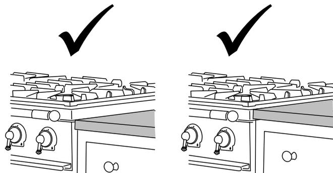
Aangrenzende werkoppervlakken dienen op dezelfde hoogte te zijn met de kookplaat of daaronder, niet met of onder het pannenkooster.
