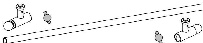
Eine Stoßkappe an den Laschen an ein Ende des Rohrs halten. Eines der Endstücke am Rohr anbringen und über die Stoßkappe auf das Rohr schieben.
