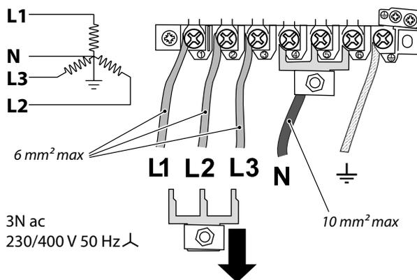
U kunt de afschermkast van het aansluitpunt op het achterpaneel verwijderen om bij de netaansluiting te komen.
