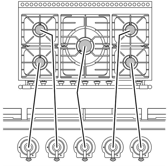
Der Herd verfügt über eine Funkenzündung, die bei gedrücktem Regler funktioniert. Alle Brenner verfügen zudem über eine spezielle Sicherheitsvorrichtung, die den Gasstrom unterbricht, falls die Flamme erlischt.
