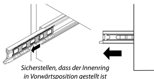
Heben Sie die Schublade an den Seiten an und platzieren Sie eine der Schienen (ca. 15 mm) auf der inneren Seitenschiene.
