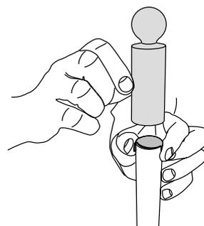
Das Rohr umdrehen und das andere Endstück mittels der zweiten Stoßkappe anbringen. Dabei darauf achten, das erste Endstück nicht zu verkratzen oder zu beschädigen und dass die beiden Endstücke richtig ausgerichtet sind.
