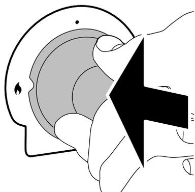
Falls der Brenner beim Loslassen des Reglers erlischt, funktioniert die Sicherheitsvorrichtung nicht. Den Regler auf Aus stellen. Den Vorgang nach einer Minute wiederholen und diesmal den Regler etwas länger und evtl. fester eindrücken.
