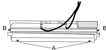
Die 2 Schrauben „A“ entfernen und die Platte herunterfallen lassen. Die 2 Schrauben „B“ entfernen, die obere Platte absenken und durch den Schlitz in der Herdrückseite entfernen. Die Anschlüsse lösen und ihre Position notieren. Die Befestigungsmittel des Herdelements entfernen und das Element herausnehmen. Das Element ersetzen und die Teile in umgekehrter Reihenfolge zusammenbauen.
