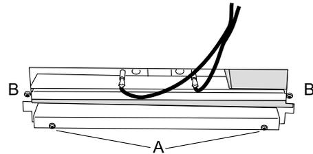
Verwijder de 2 schroeven 'A' en laat de plaat zakken. Verwijder de 2 schroeven B, laat de bovenste plaat zakken en verwijder deze door de gleuf in de achterkant van het fornuis.
