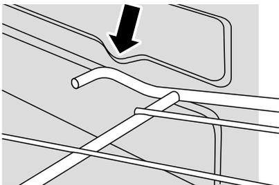
Um den Rost wieder einzusetzen, den Rost mit einer Rille in der Ofenseite ausrichten und den Rost nach hinten schieben, bis das Ende an den Schiebeleistenanschlag stößt. Den vorderen Teil anheben, sodass die Rostenden über die Schiebeleistenanschlüge gehen und dann den vorderen Teil absenken, sodass der Rost waagrecht ist und ihn ganz nach hinten schieben.
