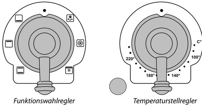
Drehen Sie den Funktionswahlregler auf eine Backfunktion. Dies ist die Umlufteinstellung.
