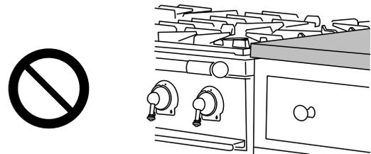
Wir empfehlen eine Lücke von 900 mm zwischen Einheiten, um Bewegungen des Herdes zu berücksichtigen. Wenn ein glatt abschließender Einbau erforderlich ist, schieben Sie den Herd an die Einheit an der einen Seite, und danach die Einheit an der anderen Seite an. Den Herd nicht einklemmen. Es muss noch immer möglich sein, den Herd zur Reinigung und Wartung hereinzuschieben und herauszuziehen.
