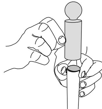
Draai de stang om en breng de tweede frictieschijf en het andere eindstuk aan. Pas op dat het andere uiteinde niet beschadigt en dat de twee eindstukken in één lijn zitten.
