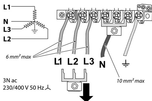
Zugriff auf den Netzanschluss erhalten Sie durch Entfernen des elektrischen Klemmenanschlusskastens an der Rückwand. Das Netzkabel an die korrekten Anschlüsse für Ihre Stromversorgungsart anschließen.
