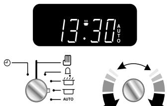
Drehen Sie den Zeitschaltuhrknopf auf die untere Stellung „Auto“. Ist die eingestellte Zeit erreicht, ertönt ein Warnton. Drehen Sie den Zeitschaltuhrknopf auf die vertikale Stellung (⌚), um zur manuellen Zubereitung zurückzukehren.
