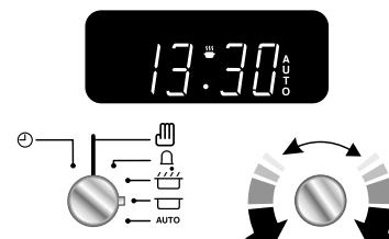
Die „Stoppzeit“ wird angezeigt, gefolgt von „AUTO“. Stellen Sie den/die Ofen/Öfen auf die benötigte Backtemperatur ein. Drehen Sie den Zeitschaltuhrknopf auf die Stellung „Auto“.
