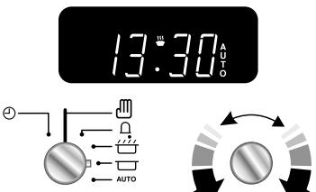
Draai de timerknop naar de instelling 'auto'. Als de ingestelde periode om is, gaat de pieper af. Draai de timerknop naar de verticale stand (□) om op handmatig koken over te schakelen.
