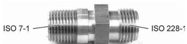
Schrauben Sie den Steckverbinder in den Herdeinlass, bis er fingerdicht sitzt. Mittels zweier geeigneter Werkzeuge (eines am Einlass des Herds, um sicherzustellen, dass er ruhig gehalten wird und einem am Steckverbinder) den Steckverbinder im Einlass am Herd festziehen.
